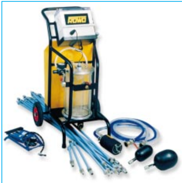
Zum Prüfen der Wasserdichtheit von Rohren und Kanälen dient das fahrbare Prüfgerät mit elektronischer Auswertung. Absperrblasen (u. r.), die über Luftschläuche und Fußpumpe (u. l.) aufgeblasen werden, verschließen die Leitung
