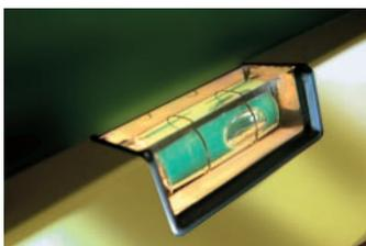
„Reca Goldstar Flash“. Trotz geringen Stromverbrauchs werden die senkrechte und waagerechte Libelle gut durch Spezial-LED's beleuchtet. Das Einschalten erfolgt durch einen stoßgeschützten Schalter, der sich an der Seite neben dem integrierten Fach für die Batterien befindet. Betrieben wird die Beleuchtung mit zwei AM2-Zellen. Die Meßgenauigkeit beträgt 0,5 mm/m. Die beleuchtete Wasserwaage ist in den drei Längen 300, 400 und 600 mm lieferbar.
