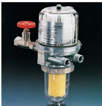
se für Einstrangsysteme vorgesehene Anlagenkomponente gewährleistet eine störungsfreie Ölzufuhr mit einer verbesserten Düsenleistung von 110 l/h bei einer Luft-Abscheideleistung von 6 l/h. Da keine Heizöl-Rücklaufleitung erforderlich ist, wird die Ölversorgung kostengünstiger und sicherer.
