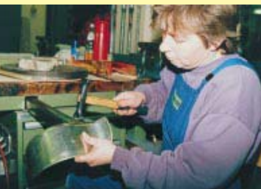
Damit die durch Drahteinlagen randverstärkten Radabdeckungen an den Seitenblechen angebracht werden können, war ein 10 mm breiter Bord erforderlich, der streckenweise gestaucht und geschweißt werden mußte
