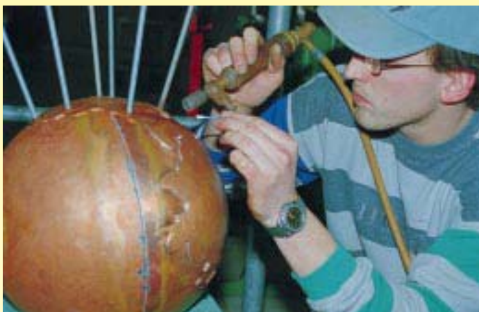
. . . bevor er sie auf der Kugel mit der Flamme verlötete, was aufgrund der unterschiedlichen Blechdicke flächig bzw. am Bördelrand erfolgte
