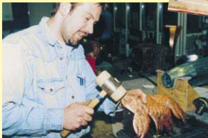
Mit Punzen wird die Form des Hahnenkörpers in eine Umrißtreibform modelliert
