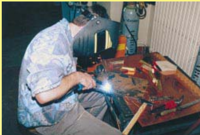
Eine exakte Schablone garantiert die gleichmäßige Form des Fußrahmens aus 22er Messing-Rundprofil . . .
