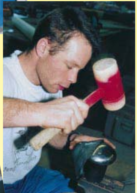
Der Bug des Luftschiffes wurde aus sogenanntem Ornamentzink getrieben ▼
