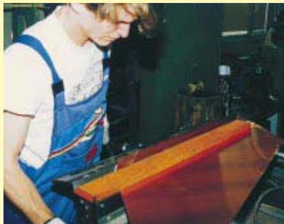
Durch den besonderen Zugschnitt verschiedener Blechteile mußten Abkantungen auf einer Magnetabkantbank vorgenommen werden
