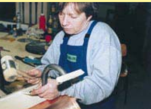
Kiesenbauer verband das geschwungene Heckblech durch Pittsburgh-Falze mit den Seitenblechen, während der Anschluß an den Sitz mit einem einfachen Falz erfolgte
