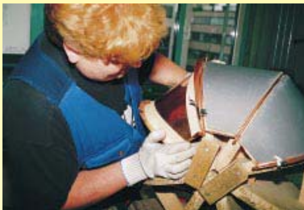
Um Fingerabdrücke auf dem walzblanken Kupferblech zu vermeiden, wird mit Handschuhen gearbeitet und das Blech durch Abdeckungen geschützt
