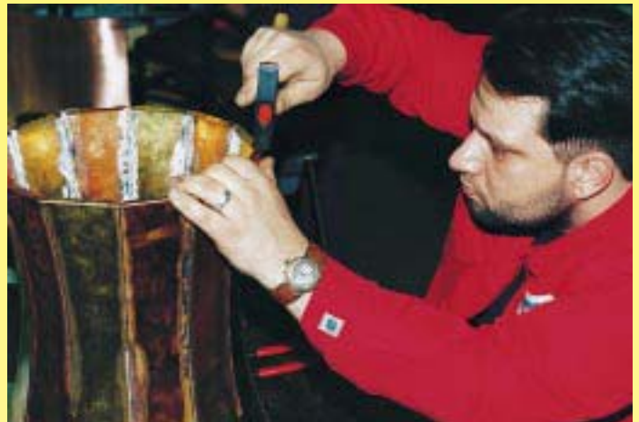
Die Segmente des Brunnenkörpers, abwechselnd in Messing und Kupfer ausgeführt, wurden durch eine innenliegende WIG-Bördelnaht miteinander verbunden
