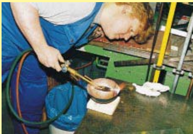
Vor dem Schlichten der getriebenen Kugelhälfte muß das Kupferblech gegläht und abgeschreckt werden
