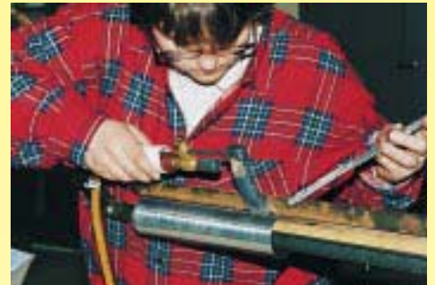
Den Vaseneinsatz lötete die Meisterkandidatin auf dem Lötbaum, einem nur noch selten anzutreffenden Hilfswerkzeug
