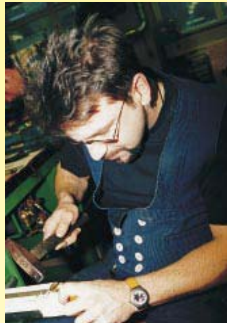
... der aus zwölf gerundeten Messingblechteilen besteht, die mit einfachen Stehfalzen verbunden sind
