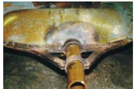
In der Werkstatt erhielt der Wetterhahn eine neue Fußhülse mit Befestigungsstreben aus Kupfer, wobei nun Edelstahlschrauben die Schalenhälften zusammenhalten
