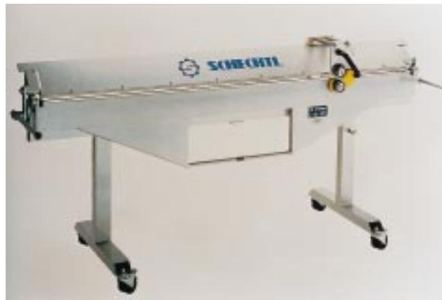
**Zur Dach + Wand '96 wurde die „Leichte Aluminium Bauabkantmaschine“ LBA 200 präsentiert, die sich noch leichter transportieren als ihre baugleiche Schwester aus Stahl**
