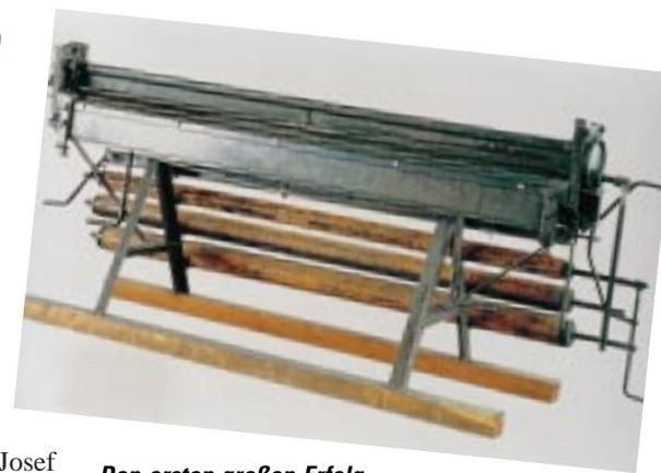
**Den ersten großen Erfolg erzielte Firmengründer Josef Schechtl mit der Handabkantmaschine KS 1 für „die Ausführung sämtlicher Bauklempnerarbeiten“**
