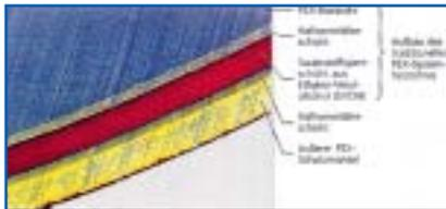
**Mikroskopische Aufnahme eines Querschnitts des Roth „Duopex“-Systemrohres in polarisiertem Licht (Ausschnitt)**
