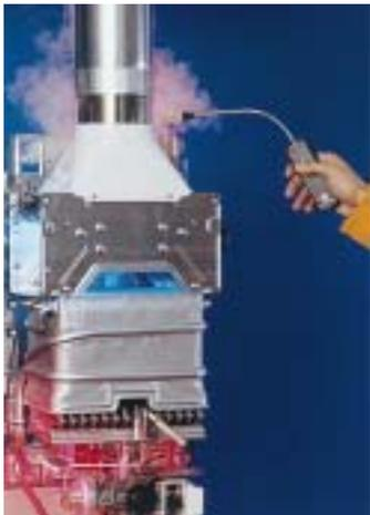
**Zum Aufspüren von rückströmendem Abgas wurde der Rückstauemelder Testo 317 mit optischer und akustischer Anzeige entwickelt**
