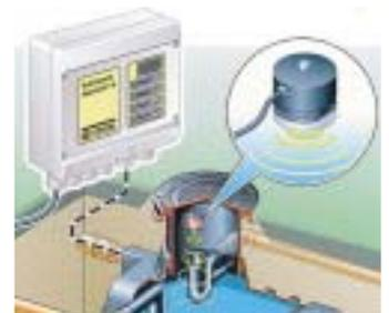
**Den Füllstand meldet der Ultraschallsensor an die Steuerzentrale**
