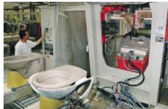
Im Duravit-Werk Meißen erfolgte die Inbetriebnahme drei neuer Druckgußanlagen für die Klosett-Herstellung
