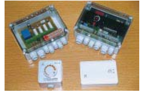
Abgasautomaten zur Steuerung von Kessel und Rauchsauger
