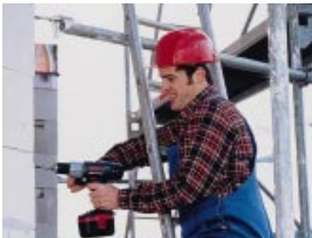
*Der Akku-Schlagbohrschrauber GSB 24 VE-2 ist mit einem 24-Volt-Akku ausgestattet, der ein rasches Arbeiten gewährleistet*
