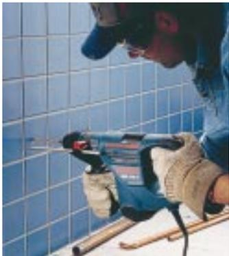
*Der 3-Kilo-Bohrhammer bohrte im Vergleichstest über 50 000 Löcher mit 14 mm Durchmesser und 85 mm Tiefe, bevor ein Wechsel des Werkzeughalters notwendig wurde*
