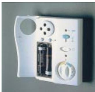
rotbedienung eine Raumwärmerung zu vorprogrammierbaren Zeiten. Bei kombiniert betriebenen Heizkörpern wird im Winter das Thermostatventil und in der Übergangszeit die Elektroheizpatrone angesteuert. Das batteriebetriebene Gerät ist 80 x 110 mm groß und kann an freiwählbarer Stelle an der Wand befestigt werden, denn es erfordert keine Kabel. Die Raumtemperatur kann zwischen +5 und +30 °C eingestellt werden
