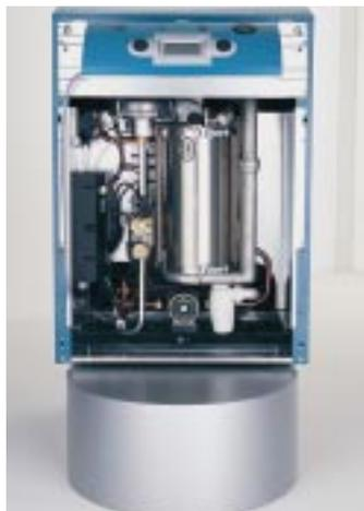
reicht einen Wirkungsgrad, bezogen auf den oberen Heizwert, von 108,5 %. Alle technischen Einrichtungen wie Umwälzpumpe, Ausdehnungsgefäß und Mischer-Erweiterung sind im Gerät integriert. Der Heizkessel arbeitet raumluftabhängig in einem Modulationsbereich von 8 bis 24 kW. Er ist sowohl für Erd- als auch Flüssiggas geeignet. Bei Bedarf kann der Kessel so eingestellt werden, daß er die Grenzwerte des Hamburger Förderprogramms erfüllt.
