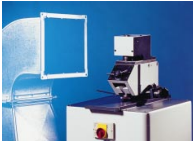
Zum Aufrichten der für die Pittsburghfalze erforderlichen Borde an den Seitenblechen verwendet man Tisch-Bördelmaschinen
