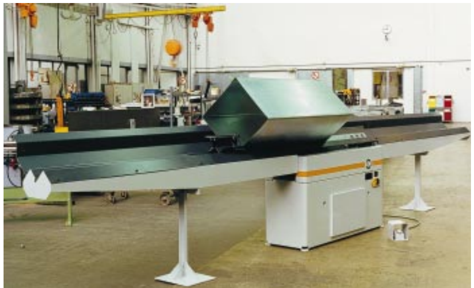
Zur wirtschaftlichen Herstellung rechteckiger gerader Luftkanäle bedient man sich vorzugsweise einer Kanalfalzmaschine
