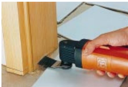
Ein- und Ausschnitte sowie Aussparungen lassen sich mit dem Sägesystem E-Cut herstellen, das für zwei oszillierende Maschinen von Fein konzipiert wurde
