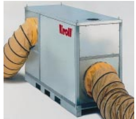
Die mobile Heizzentrale HM, mit 2400 mm Länge, 820 mm Breite und 1450 mm Höhe, kann mit Heizöl, Propan- oder Erdgas betrieben werden
