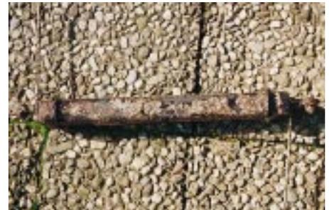
**Ist der Elektrolytstand im Tank nicht ausreichend, können die Anoden selbst nach Jahren noch so gut wie unangetastet ausgebaut werden [4]**
