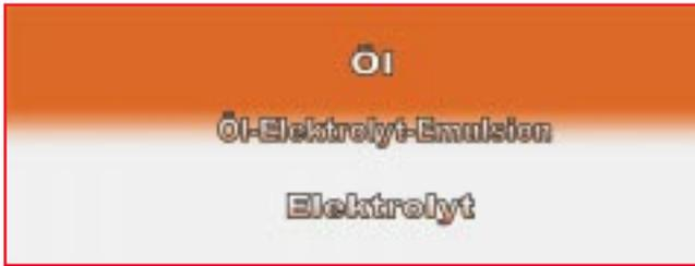
**Die Öl-Elektrolyt-Emulsionsschicht muß so dünn wie möglich gehalten werden; das erfordert besondere Zu- und Abläufe**
