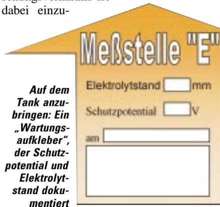
halten. Von dieser Flüssigkeit wird nun soviel in den Tank gegeben, bis die Anoden vollständig überspült sind. Dabei sind die Anoden mindestens 5 mm zu überdecken, und an der höchsten Stelle am Tankboden muß die Elektrolythöhe mindestens 20 mm betragen. Deshalb wird der Einsatz des inneren kathodischen Korrosionsschutzes nur in standortgefertigten Heizöltanks nach DIN 6625 (Tanks mit ebenen Böden) als fachlich sinnvoll angesehen. Ein Hinweisschild am Tank muß auf den Elektrolytstand hinweisen.
