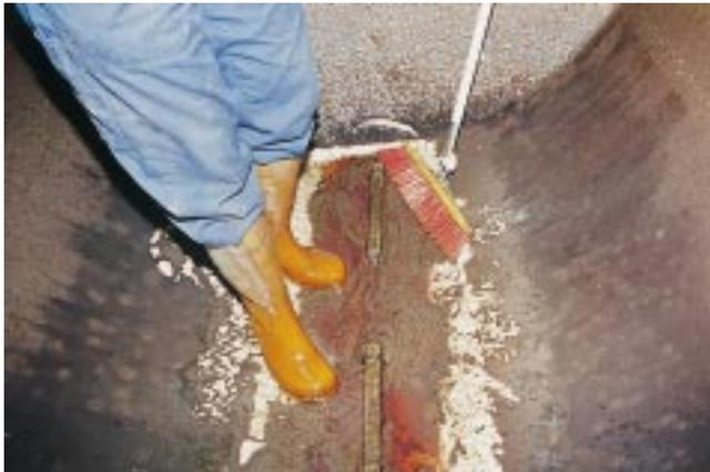
**Auch das gibt's: Bei einer Tankinspektion wurden Opferanoden in einem innenbeschichteten Öltank entdeckt [4]**
