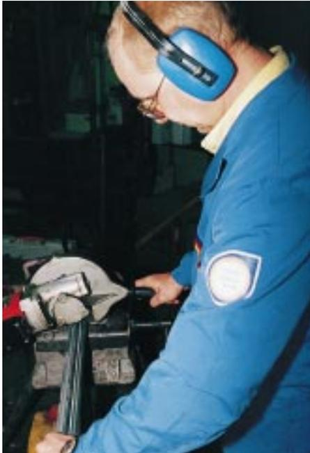
*Die Unterkonstruktion der Trockenbauwand aus GIS-Profilen wurde mit einer elektrischen Metallkreissäge in der Werkstatt des Installateurs zugeschnitten und zusammengesetzt*
