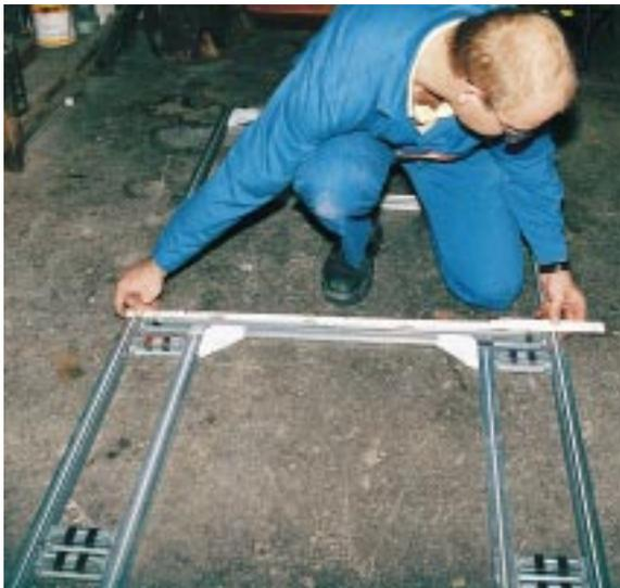
*Damit sich der Rahmen beim Transport nicht verwindet oder aus dem Winkel gerät, bringt der Installateur in einigen Kanten Transportsicherungswinkel an*
