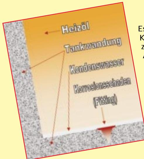
Es gibt Fälle, in denen kathodische Korrosionsschutzanlagen in Öltanks zum Ausfall der Ölheizung führten. Aber ist in Öltanks überhaupt ein Korrosionsschutz nötig? Und wenn ja, worauf ist zu achten, damit spätere Betriebsstörungen ausbleiben?
