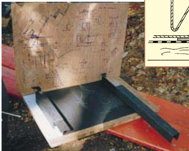
Tetraederstumpf: An einem Modell wurde die zur Ausführung gekommene Scharenverbindung den an der Verwirklichung der Turmbekleidung Beteiligten verdeutlicht, ...
