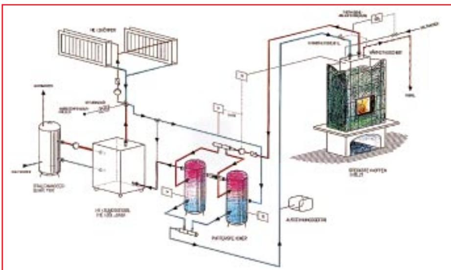
Wird der Specksteinofen in ein komplettes Heizsystem integriert, kann der konventionelle Heizkessel extrem klein dimensioniert oder durch eine Solaranlage ersetzt werden
