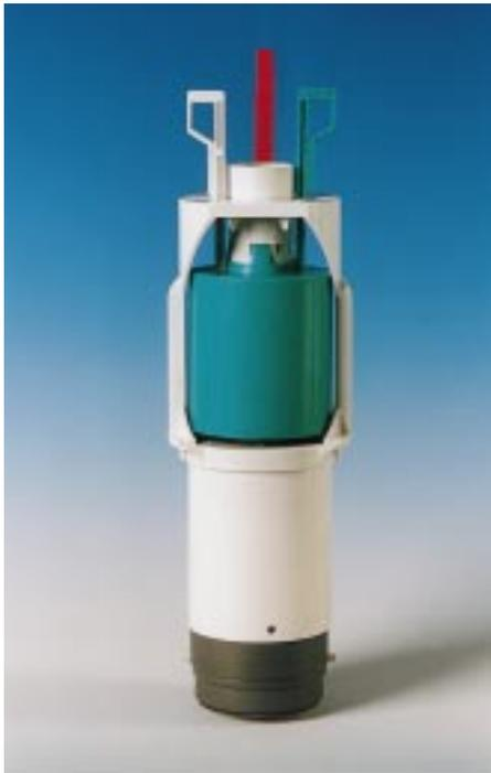
**Verbessert wurde die Zwei-Mengen-Ab-laufarmatur des Unterputzspülkastens, so daß z. B. in Verbindung mit Friaplan ein Schall-druckpegel von 19 dB(A) erreicht wird**
