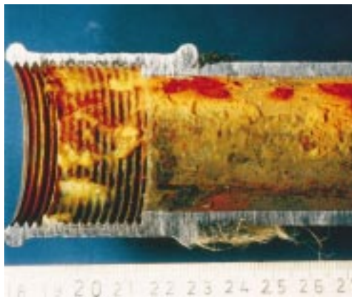
Detail Vergrößerung; aktive Korrosionsstellen unter mangelhafter Beschichtung. Betriebszeit ca. 1/2 Jahr nach Beschichtung
