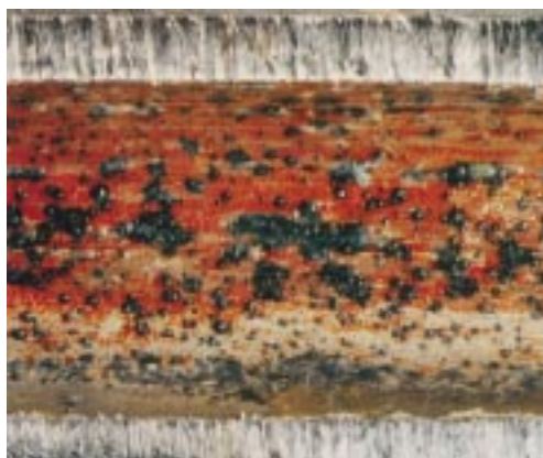
Rohrerservat 1/2" verzinkt, unvollständig gereinigt, Rostfahnen und Korrosionsspuren unter extrem dünner Kunststoffbeschichtung erkennbar
