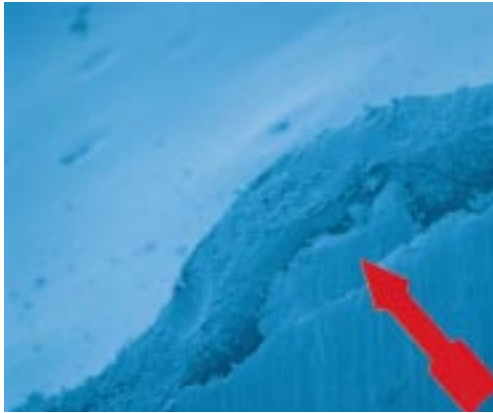
REM – Ver- größerung 500:1 Beschichtung weist teilweise Blasen auf, die praktisch die Beschichtungs- dicke durch- messen
