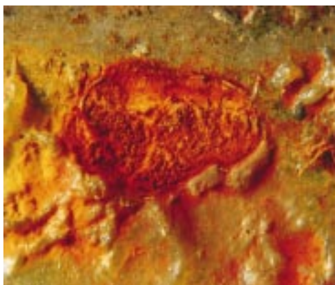
Rohrerservat 1/2" verzinkt, unvollständig gereinigt, Rostfahnen und Korrosionsspuren unter extrem dünner Kunststoffbeschichtung erkennbar
