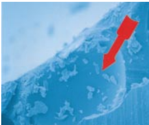
REM – Ver- größerung 500:1 Beschichtung weist teilweise Blasen auf, die praktisch die Beschichtungs- dicke durch- messen
