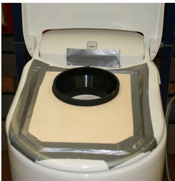
Abbildung 7: auf dem WC-Sitz befestigte Holzplatte mit Textilfließ
