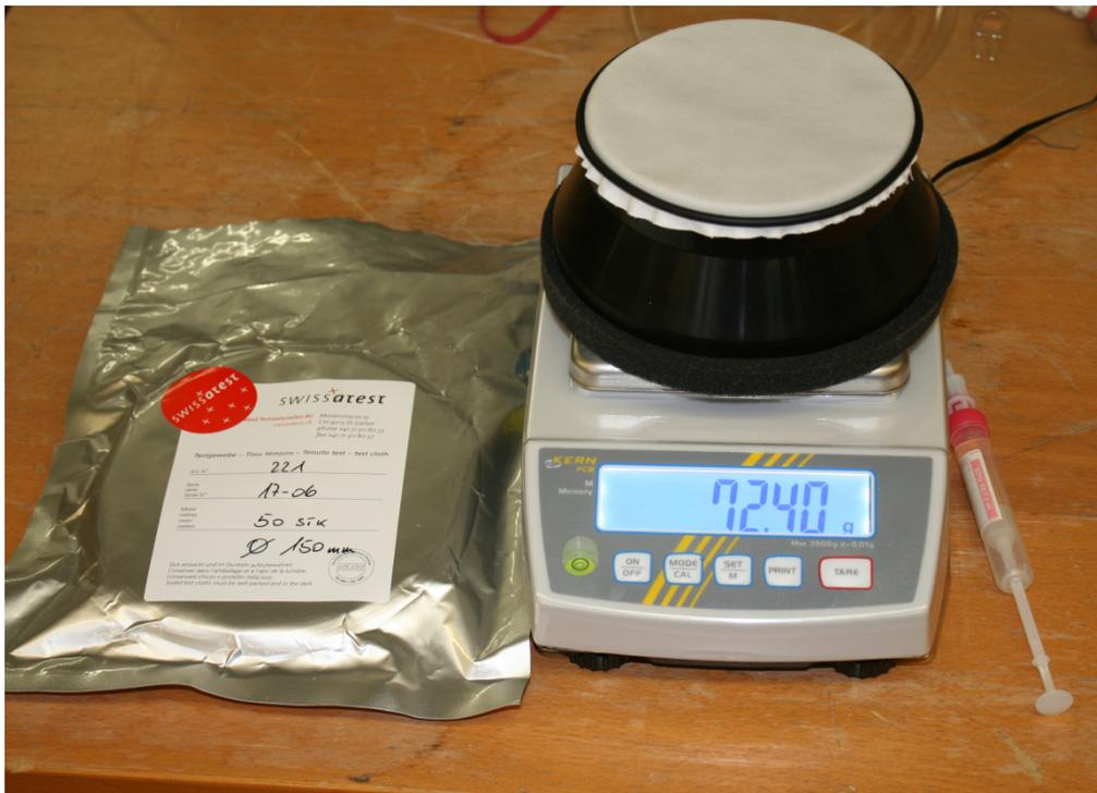
Abbildung 12: Waage mit Vorrichtung zur Bestimmung der Trocknungsrate
