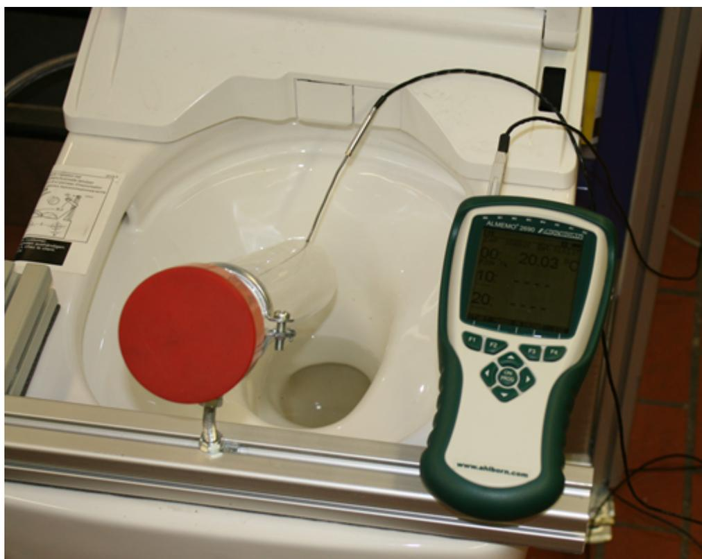
Abbildung 10: Vorrichtung zur Messung der Warmwasseraustrittstemperatur aus der Düse
