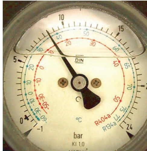
Abb. 2.19 Manometerablesung: p_e = 8,5 \text{ bar} , Barometerstand p_a = 1 \text{ bar} , absoluter Druck p_{\text{abs}} = 1 \text{ bar} + 8,5 \text{ bar} = 9,5 \text{ bar} . Die Genauigkeitsklasse beträgt 1,0 (Kl. 1,0). Das bedeutet, dass die Messungenauigkeit des Manometers 1 % vom Endausschlag (hier 24 bar) beträgt, also 0,24 bar. Der angezeigte Druck liegt also im Bereich 8,5 \pm 0,24 \text{ bar} , also zwischen 8,26 und 8,74 bar.
