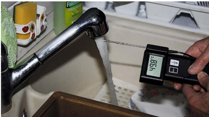
**Abb. 3.5:** Für Warmwasser genügen 50 °C an der Zapfstelle völlig. Nur bei Bevorratung muss der Speicher zum Schutz vor Legionellen regelmäßig auf mindestens 65 °C aufgeheizt werden.
