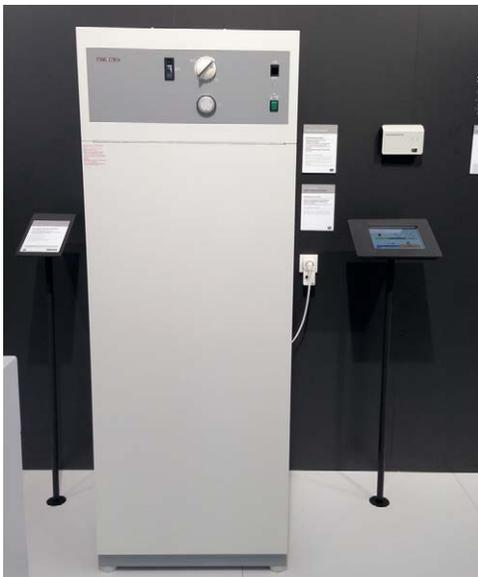
**Abb. 3.6:** Abluftwärmepumpe zur Warmwasserbereitung (WWK-300): Sie kann über den Energiemanager des Photovoltaiksystems angesteuert werden, um Sonnenstrom direkt für den Verdichter zu nutzen. Ein integrierter Speicher kann 300 Liter warmes Trinkwasser vorhalten.
